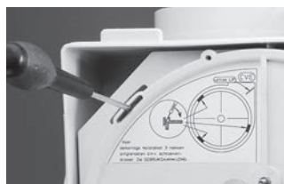
Demontage motorplaat.
